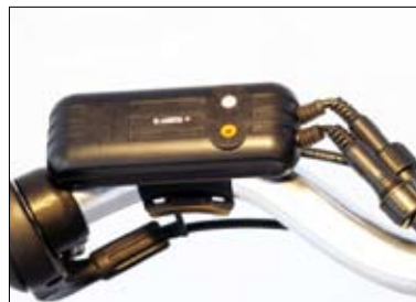
B&M E-WERK, de witte en oranje knopjes zijn voor het instellen van de maximale spanning en stroom.
